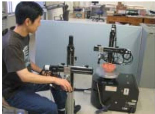
図 4：遠隔陶芸ロボットシステム
