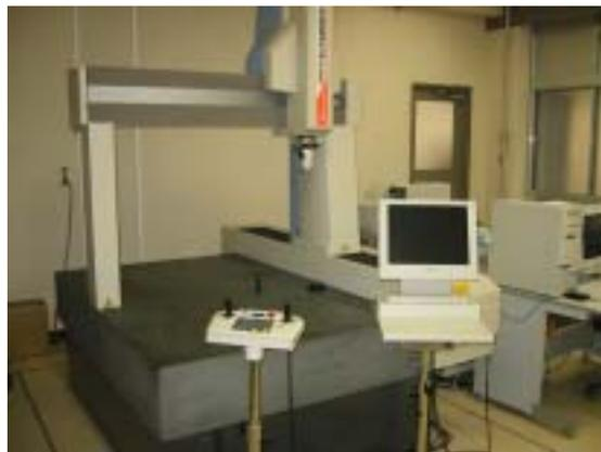
3次元精密形状計測システム
