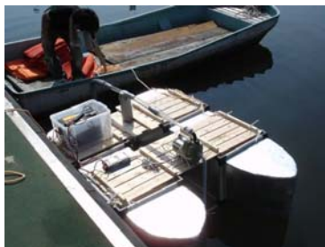
312 気泡排出型水力船 (船長若林) 気泡で水中に空気を送る環境型ロボット
