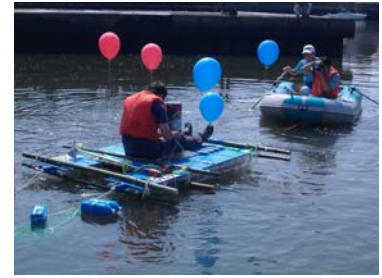
320 マイちゃん1号 堀川の水面のごみを回収しながら、 水中撮影するロボット
