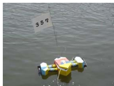
357 キョンDX スクリューで動きながら、網でゴミを取る
