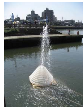
333 ろ過山脈 ペットボトルを使った噴水で、川の 水をろ過する山形ロボット
