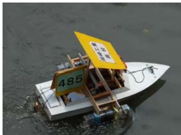
485 水質浄化ロボット? 炭で川の水をろ過する船舶ロボ ット
