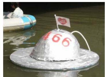
466 マッハ! 剛! Go! 号 水上からエアを水中に送りつ つ浄化もする丸型ロボット
