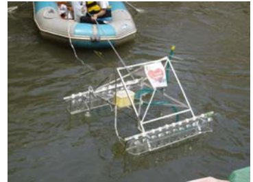
484 Aeration ポンプを使って水をばっ気する ロボット
