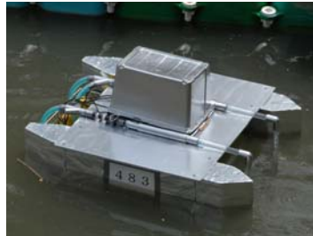
483 ギンギラギン ポンプで微細気泡を発生させな がら進行する船
