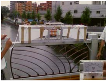
401 ASD-new 堀川の流れて発電し、電圧を測り、かつ電圧を表示する。
