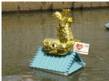
489 金色の希望 屋根の中でろ過とばっきをする 金鯱型ロボット
