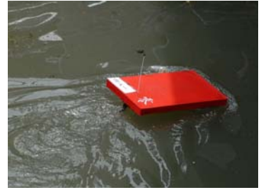
481 SNEG 水中でろ過してごみを取り、水を 綺麗にする赤くて目立つロボッ ト
