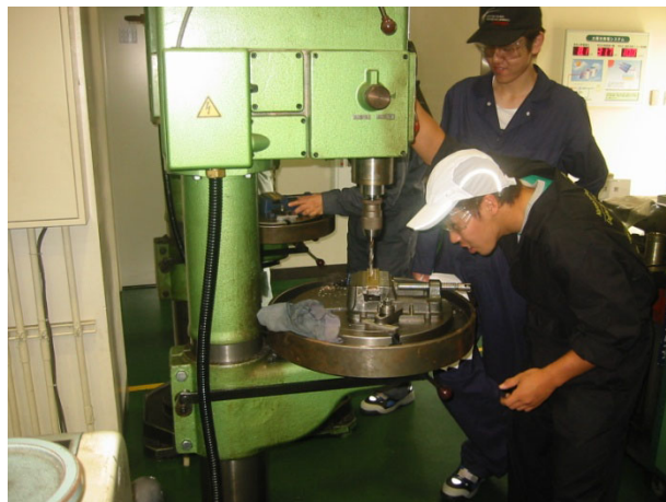
ボール盤作業をする受講者
