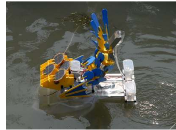
453 魚虎(しゃちほこ) ラジコンで遠隔操作し、川を流れ ているごみを回収するロボット
