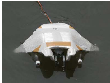
452 MANTA Jr. マンタ型ごみ取りロボット
