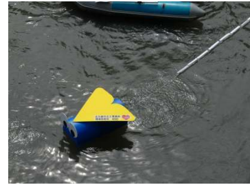
450 エコむし2 走りながらゴミを集めるロボッ ト
