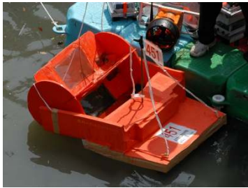
451 助光ファイヤー001号 水上に浮かび自走し、ゴミを回収 するロボット
