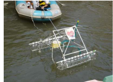
484 Aeration ポンプを使って水をばっ気する ロボット
