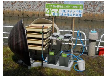
463 シジミ型水質浄化ロボット改良Ⅱ型 貝などの生物を使って水中の浮 遊物を取り除き水質を改善する ロボット
