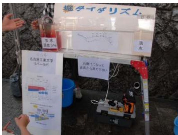
464 堀タイダリズム 潮汐による塩水の流動を可視化 する実験装置
