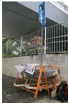
591 折り船の水中翼付き多機能 帆船(モデル) 水中ヨクを有する帆船で搭載す る装備により多岐にわたり利用 できる多目的機能を有する船型 ロボット
