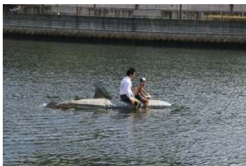
581 ジンバイザメ (サイクロン号) 口からゴミを集めるジンバイザメ型ロボット
