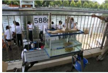
588 象さんの鼻 バキューム式浚渫船(しゅんせつ せん) 水底のヘドロと土を吸う ロボット
