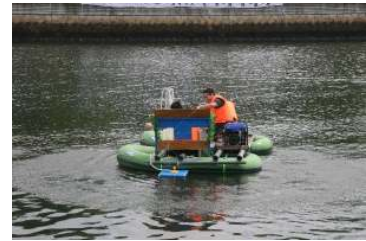
573 ヘドロ水浄化ロボット ウォーターエコ4号 凝集剤でヘドロを沈降させる、ヘドロ水浄化ロボット
