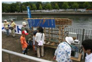
598 生物浄化装置 シジミでクリーン 石炭火力発電所から排出される クリンカアッシュを生息基盤と してシジミを飼育し、河川水中 の懸濁物をろ過させて透視度を向 上させる装置
