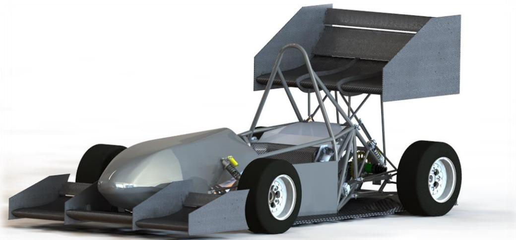
2015 年度の当プロジェクトは、全日本学生フォーミュラ大会での総合 800pt 獲得および表彰台登壇（総合 6 位以上）を目標に掲げ 1 年間活動してまいりました。この目標のもと設計・製作した 2015 年度の車両“N.I.T.-13”は、単気筒 450cc エンジンに 10inch ホイールを採用した軽量・コンパクトなパッケージングという前年度車両までの設計思想を引き継ぎつつ、車両前後に大型ウイングを搭載するなど、新たな試みを取り入れた車両であり、大会時のタイムで 2014 年度車両から約 2 秒のタイム短縮を達成しました。
