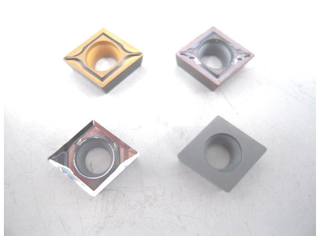
各種材料加工用チップ 鉄（左上） ステンレス（右上） アルミ（左下） 真鍮・鋳鉄（右下）
