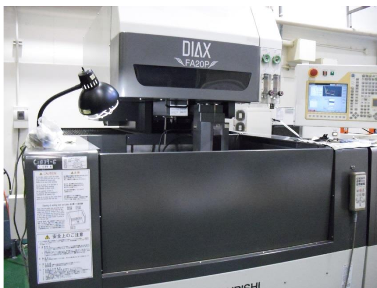
ワイヤ放電加工機 (三菱電機 FA20)
